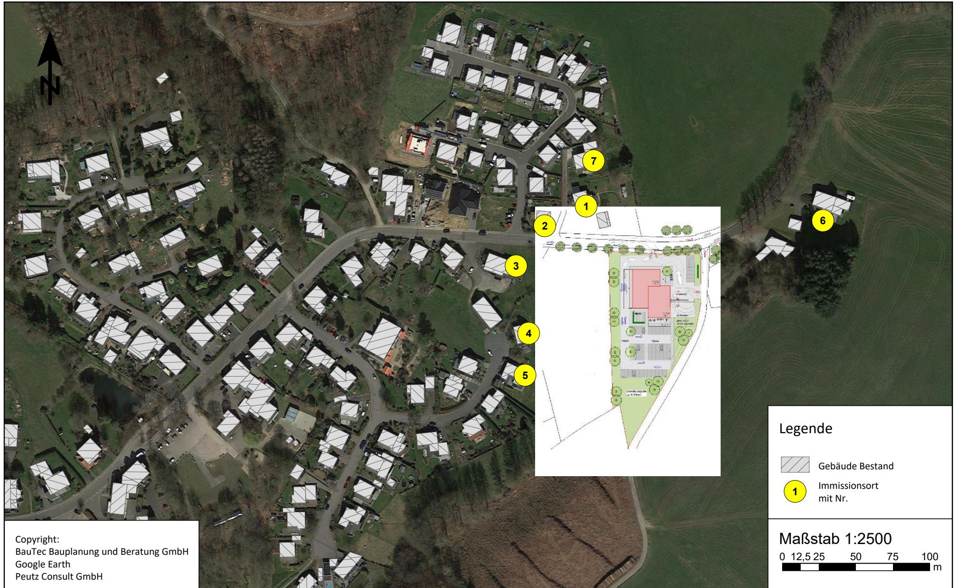
Detaillageplan des digitalen Simulationsmodells mit Kennzeichnung der Schallquellen
